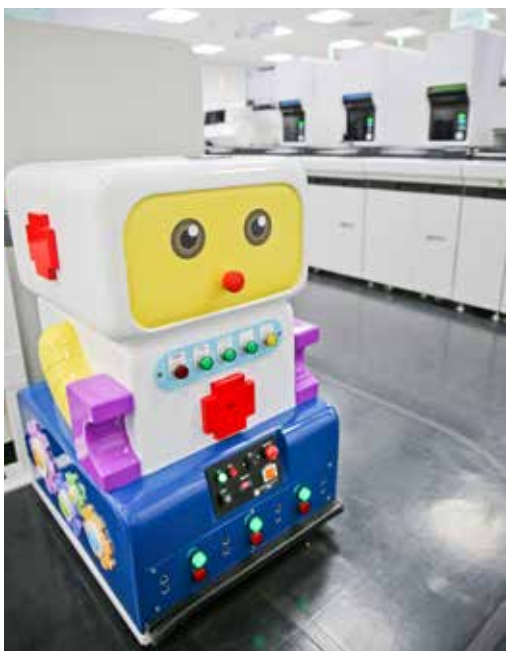
「檢體傳送機器人」能減少人員接觸檢體與移動中檢體傾倒的機會，並降低檢體間交叉感染的風險。
