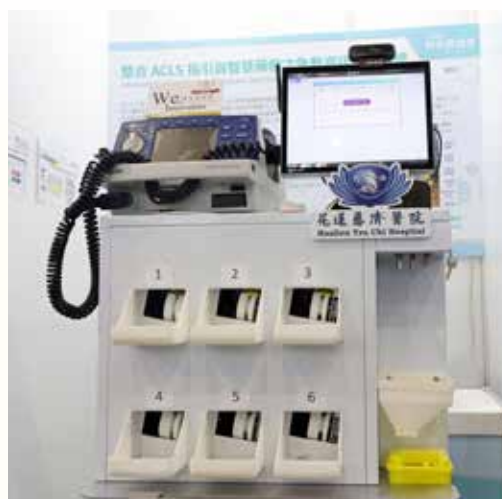
急救智慧醫療車整合 ACLS 資訊系統、臨床生理監測與智慧藥櫃，不僅能幫助醫護人員用藥與交接，也能依據病人當下的情況，自動給予急救團隊最佳化的處置流程。
