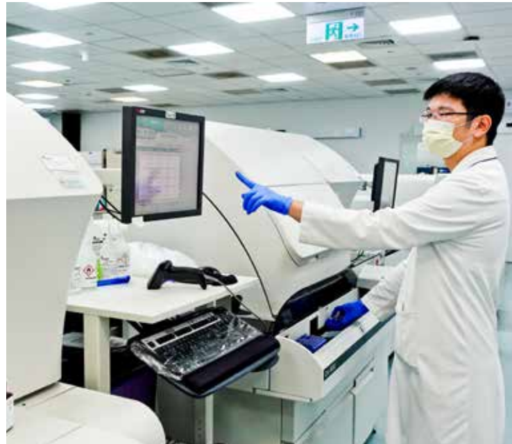
檢驗醫學科打造智能實驗室，檢體經由軌道傳輸系統自動送達檢驗儀器，有效提升效率並降低人為疏失。攝影／卓冠伶
