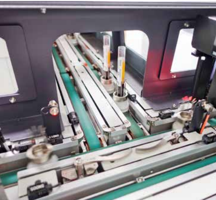
檢驗醫學科打造智能實驗室，檢體經由軌道傳輸系統自動送達檢驗儀器，有效提升效率並降低人為疏失。攝影／卓冠伶
