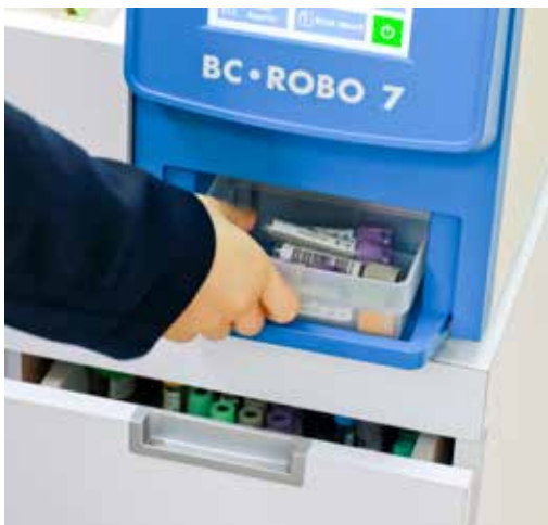
檢驗醫學科導入「智能抽血備管系統」，可依檢驗單自動備妥所需檢體試管，提升準確性與作業效率。攝影／賴廷翰
